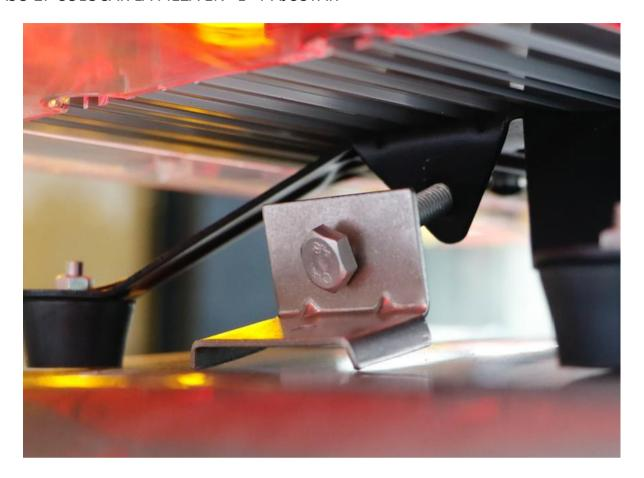
PASO 3: COLOCAR EL TIRANTE Y AJUSTARLO AL HUECO DE LA PUERTA DEL VEHICULO
